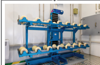
ПКТБА-НБ-МК Термостабилизация и складирование баллонов
